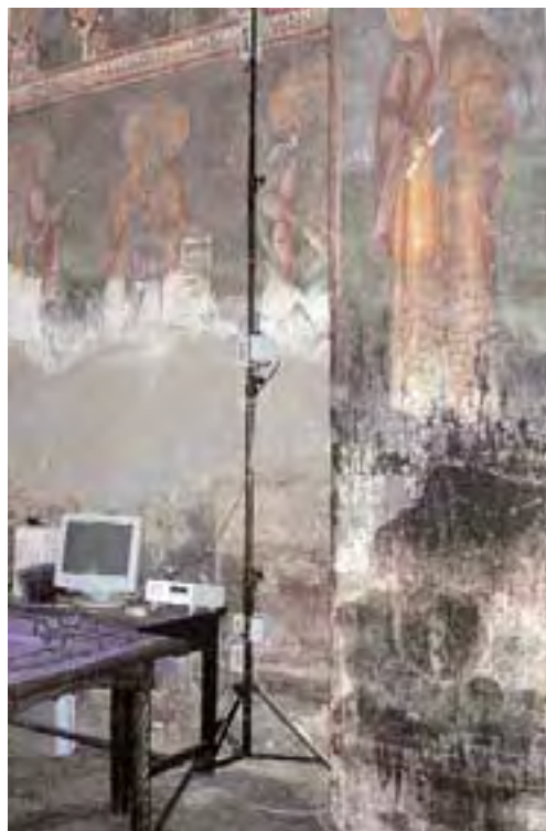
Сл. 15 - Италијанска невладинa организација Intersos поставила је уређај за праћење и бележење промена влаге и температуре у пећким црквама; централни уређај је у северозападном углу припрате, а сензори су у свим црквама и споља на цркви Св. Николе
